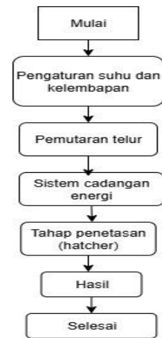
Gambar 3. Flowchart prinsip kerja mesin penetas telur otomatis
