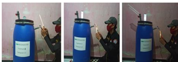
Gambar 5. Uji Nyala Api yang Dihasilkan Digester
