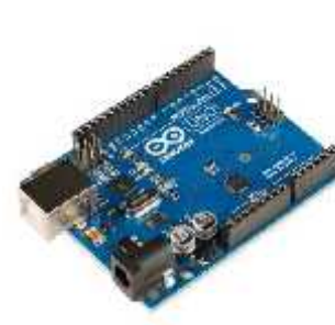
Gambar 4. Arduino Uno R3 Sumber : (Tahir, 2015 : 20)
