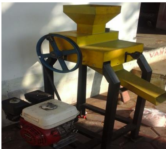
Gambar 11. Hasil Rancangan Mesin Penggiling Jagung
