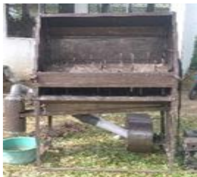
Gambar 3. Mesin Perontok Padi Hasil Fabrikasi
