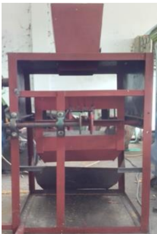
Gambar 3. Hasil Rancangan Mesin Pengayak Gabah Padi
