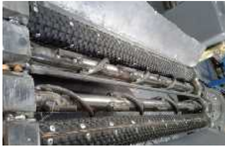
Gambar 10. Poros Karet Pengupas Kulit Jagung dan Pengantar Jagung
