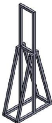
Gambar 5. Rangka Penyangga Kondensor
